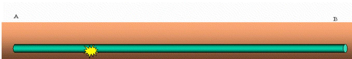
のプロセスを観ることができます。この観測点Pが区間A Bを黄金比に内分する点で、ここで測定し、次に水（もしくはガス）漏れのある側をさらに黄金比で内分し続け区間を狭めていく調査をすれば、最も速く穴の場所が特定できる。
